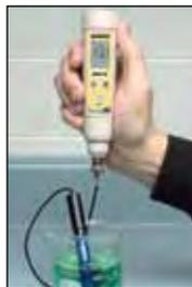
Uso con conexión directa o electrodos cableados.
