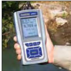
**Cubierta de caucho protege medidor en ambientes rugosos.**
