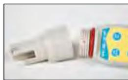
El sensor incluye sondas para pH y para conductividad/TDS/salinidad
